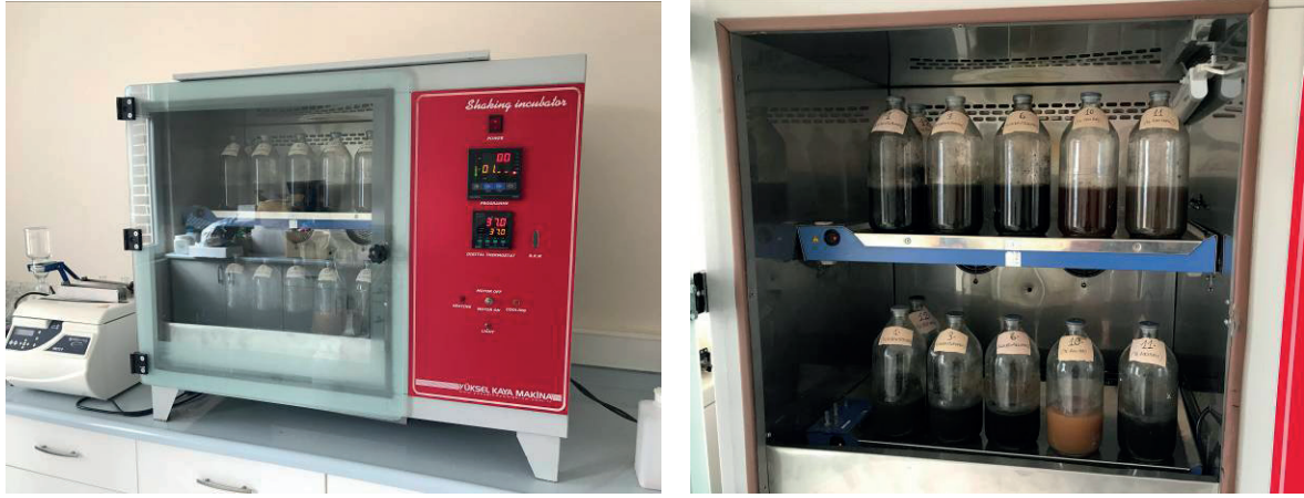
Şekil 2. Deneysel çalışmada kullanılan sıcaklık kontrollü Çalkalamalı İnkübatörün görünüşü
